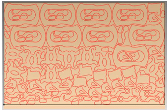
**Neue algorithmisch überarbeitete Textfunktion.** Die Textfunktionen erzeugen die Schrift nun nicht mehr als segmentierte Polylinie, sondern als Polylinie mit Kreisbögen. Dadurch verbessert sich die Laufruhe von CNC-Programmen, welche aus Texten erstellt wurden.
